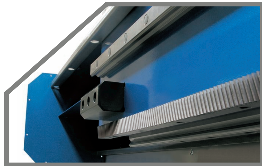
Particolare della trasmissione dell'asse "Y" con doppia guida a 90°
